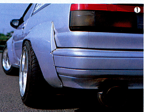
①サーキット走行をしているハチロクに装着率が高いN2オーバーフェンダー。太いタイヤが履けるし、トレッドが広がるからコーナリング性能がグーンとアップ。また、マルチリンクを移植したことで、ホイールベースが伸びたため、オーバーフェンダーも後方にズラしている。
